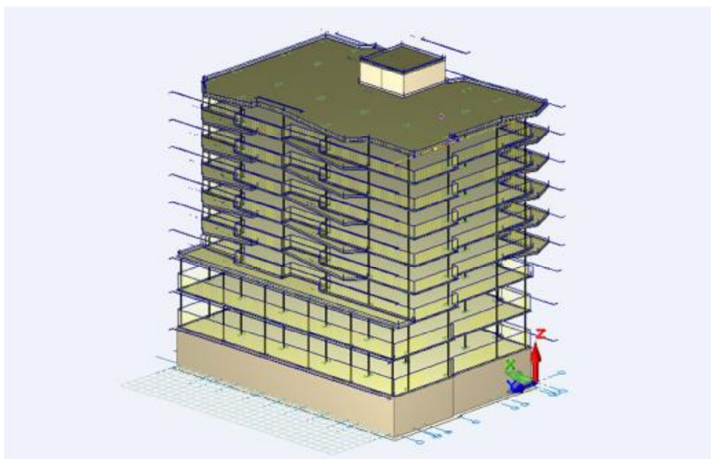
Рис.3.14. Аналитическая модель до пересечения стержней и пластин
