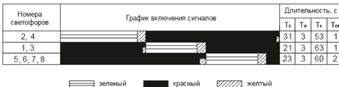
Рис. 17. График работы светофорной сигнализации
