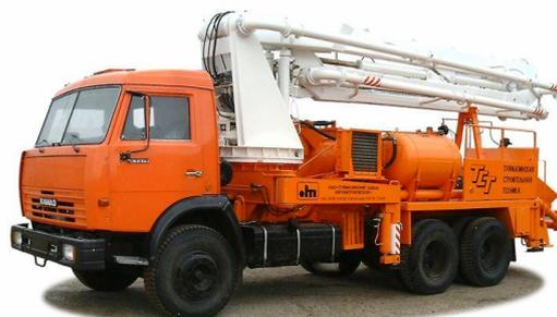
Рис. 3 Автобетононасос СБ-126
