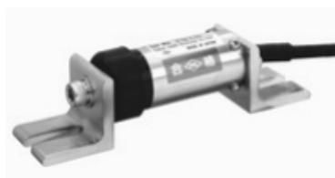
**ДАТЧИК РАСКРЫТИЯ ТРЕЩИНЫ KG-A**
