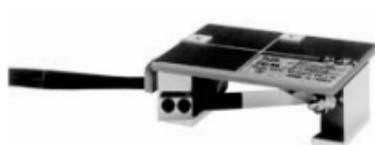
**ДАТЧИК РАСКРЫТИЯ ТРЕЩИНЫ KG-B**
