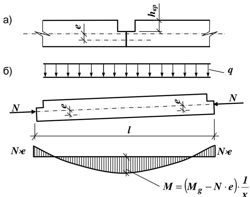
Рис. 5.6. Внецентренное стыкование в узлах (а) и расчётная схема верхнего пояса (б)
