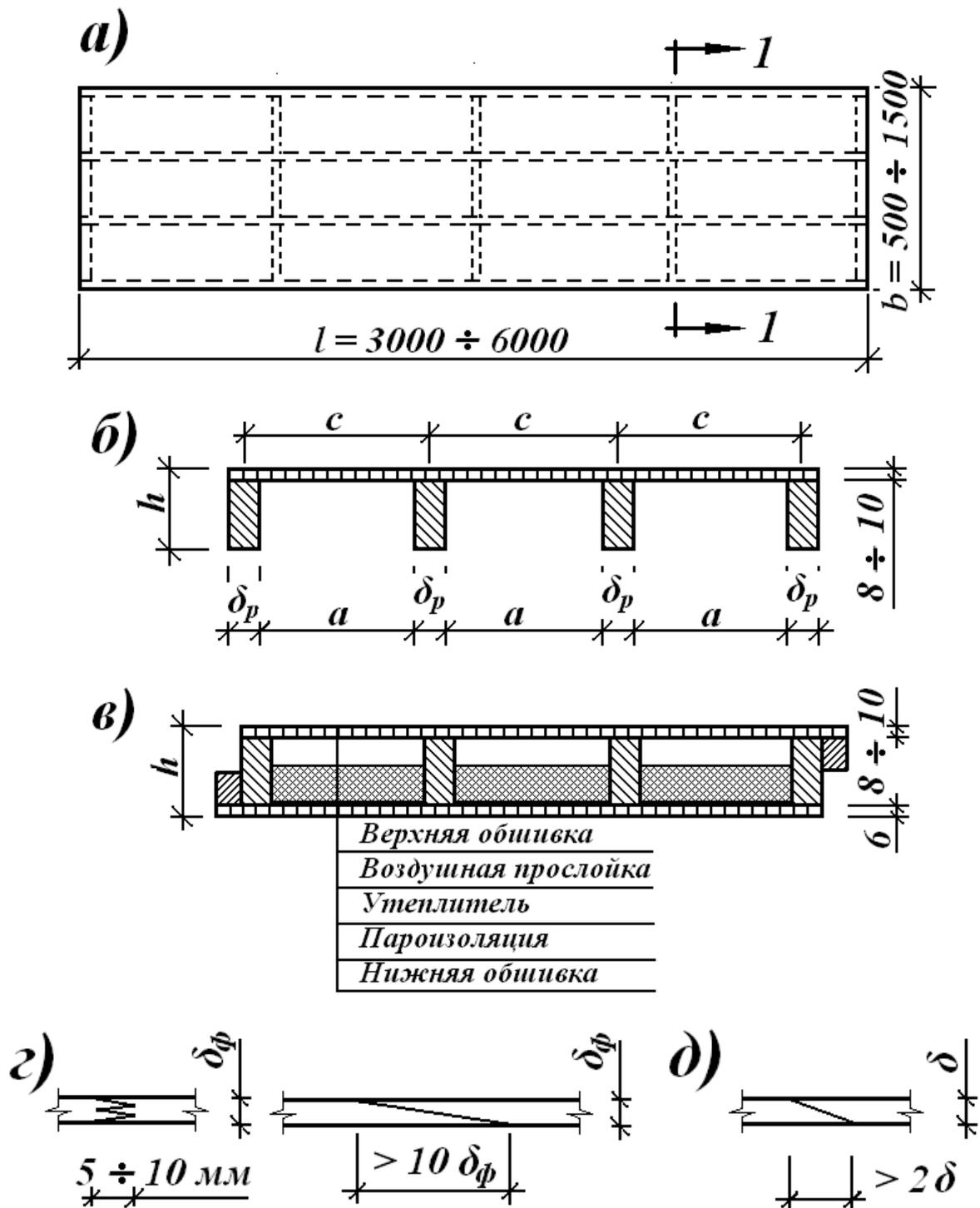
Рис.5.4. Конструкция клефанерных панелей:
