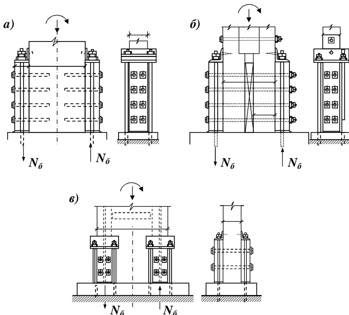
Рис. 5.11. Конструкции закрепления стоек в фундаментах:
