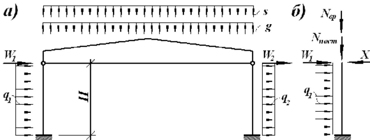
Рис. 5.9. Расчётная схема рамы (а) и стойки (б).
