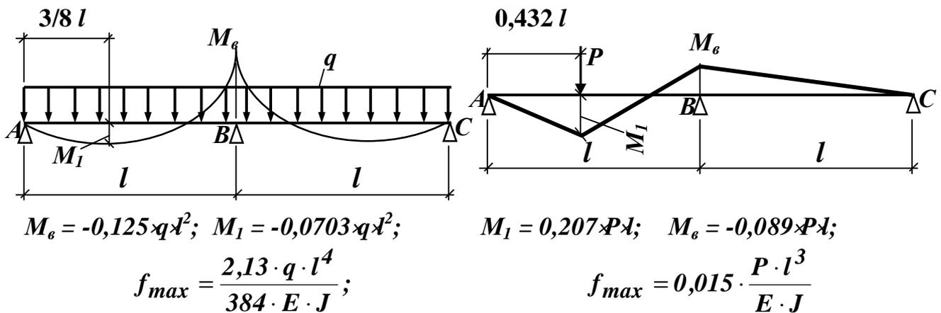
Рис. 5.5. Расчётная схема настилов и обрешетки
