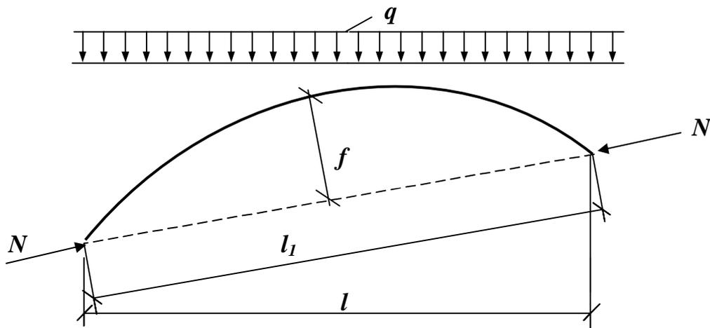
Рис. 5.7. Расчётная схема панели верхнего пояса сегментной фермы
