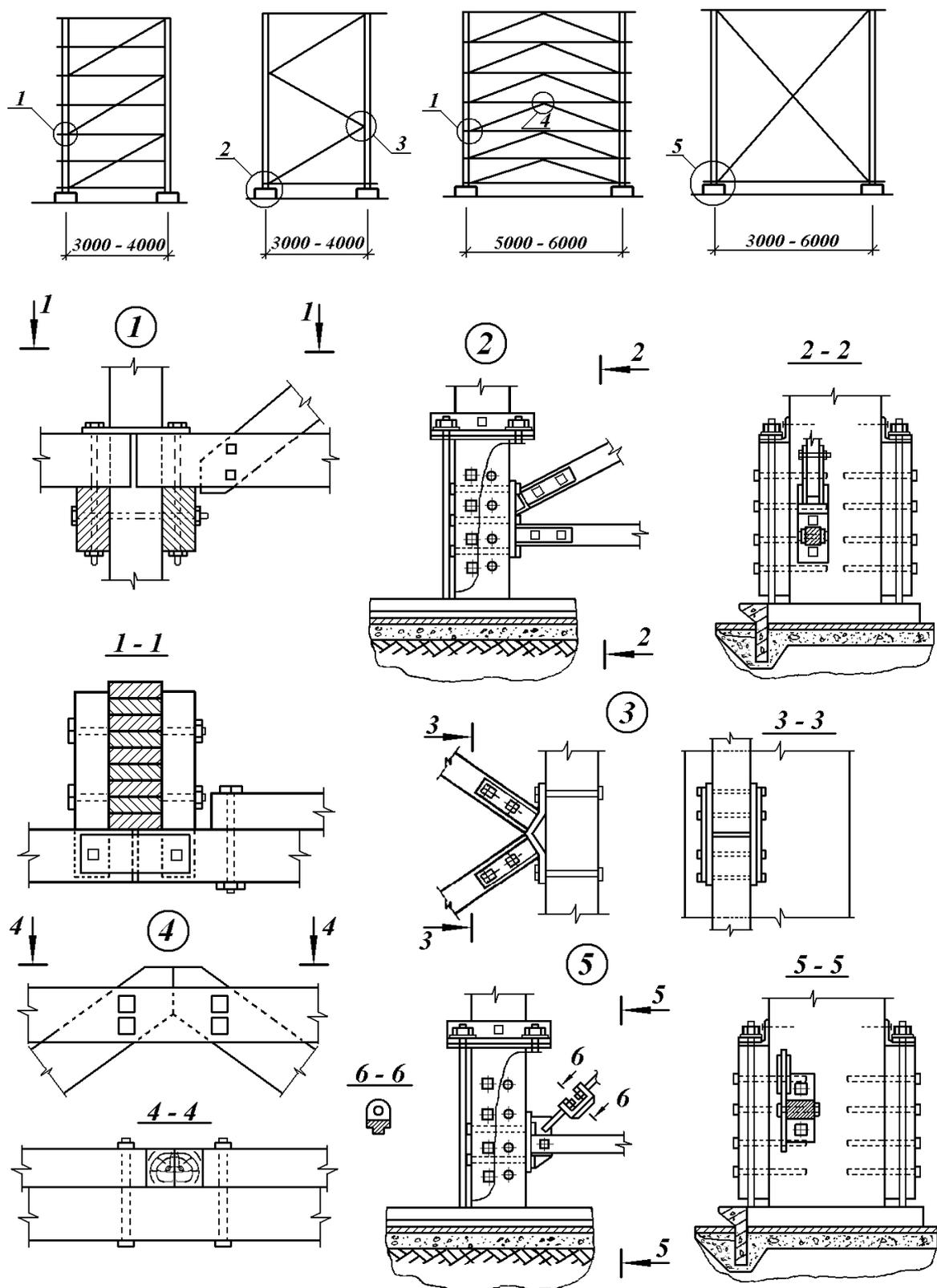
Рис.5.13. Схемы и узлы вертикальных связей между колоннами.
