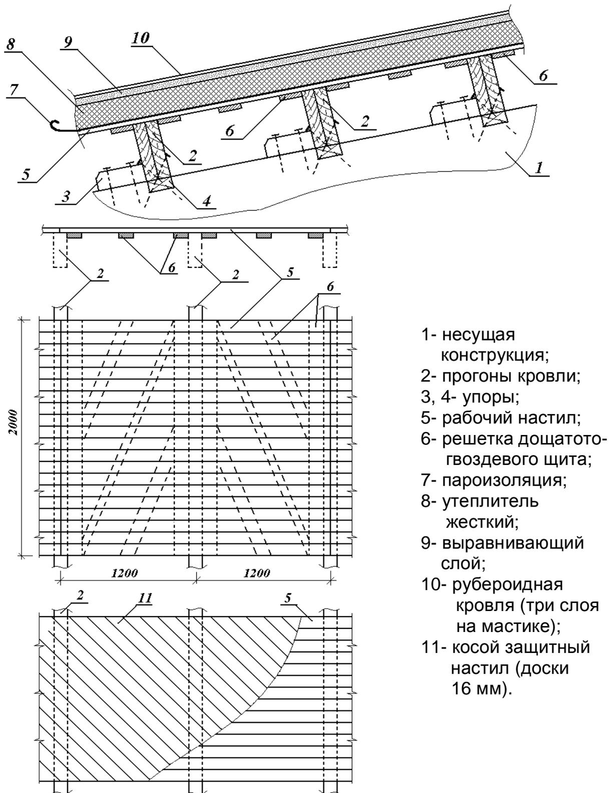
Рис.5.1. Схема утепленного непрветриваемого покрытия по прогонам.
