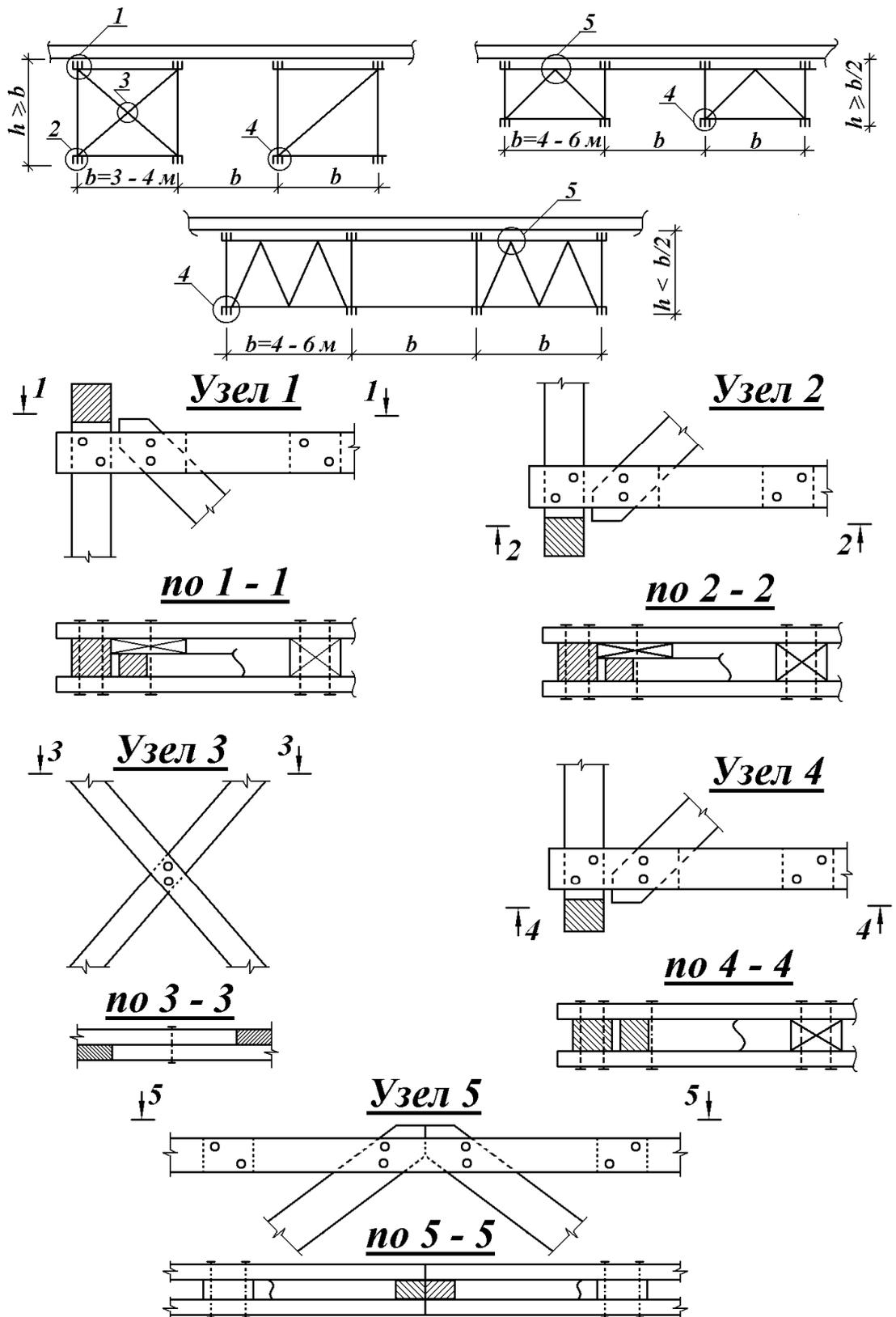
Рис.5.12. Схемы и узлы вертикальных связей между фермами.
