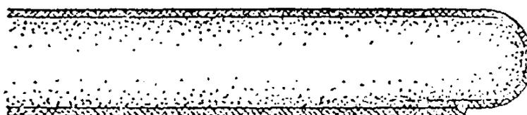
Рис. 6. Закругленная кромка (ЗК).
