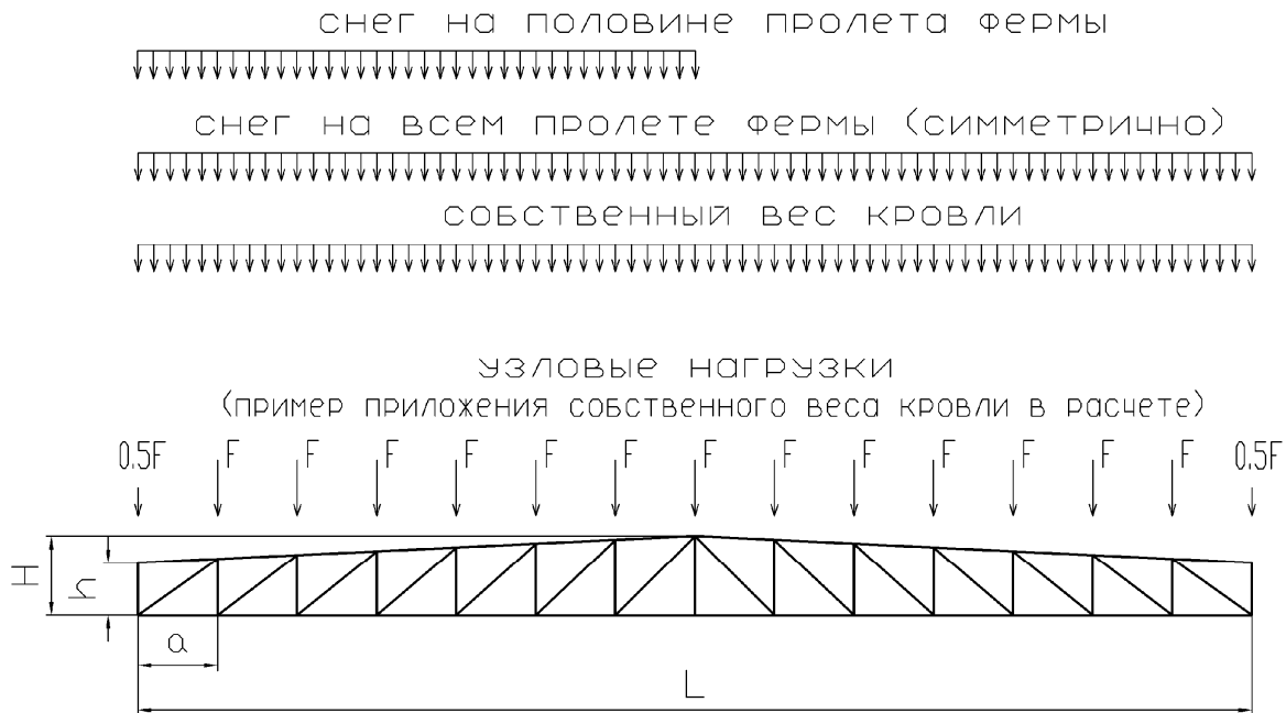
Рис. 3. Расчетная схема фермы и схемы нагрузок
