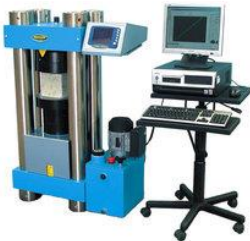
Рис. 1. Испытательный пресс для определения прочностных характеристик материалов
