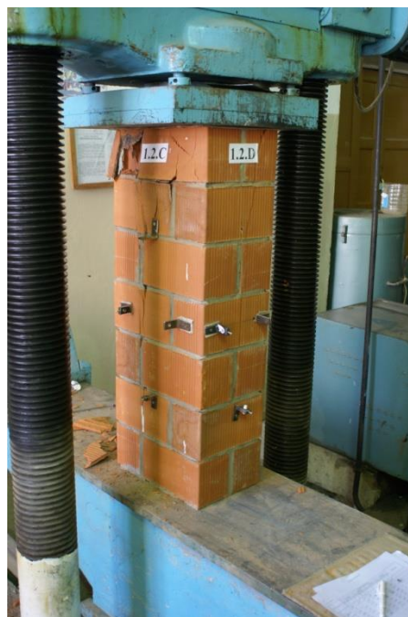
б. Начало трещинообразования
