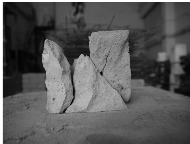
Характер разрушения опытного образца
