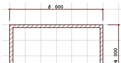
Рис. 1.33. Ассоциативная размерная линия горизонтальной стены
