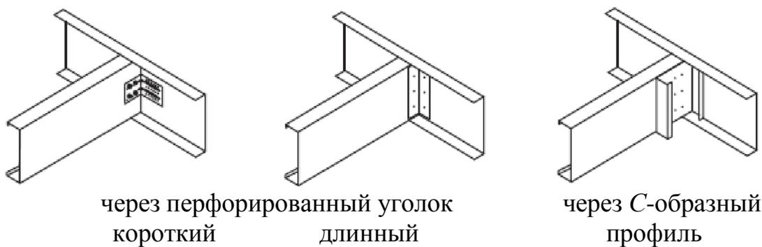
Рис. 5.8. Узлы соединения отдельных элементов из тонкостенных холодногнутых профилей.
