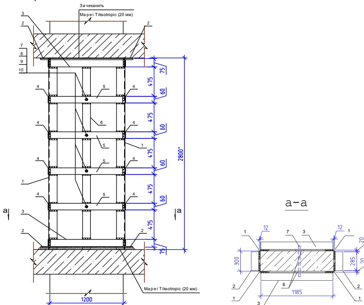
Принципиальная схема усиления стен в местах образования трещин
