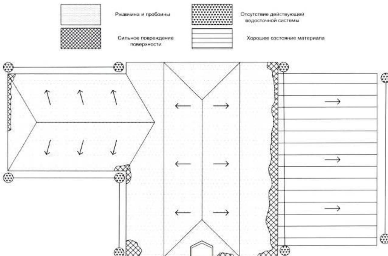
Рис.3. Дефектная карта элемента здания - кровли (пример)
