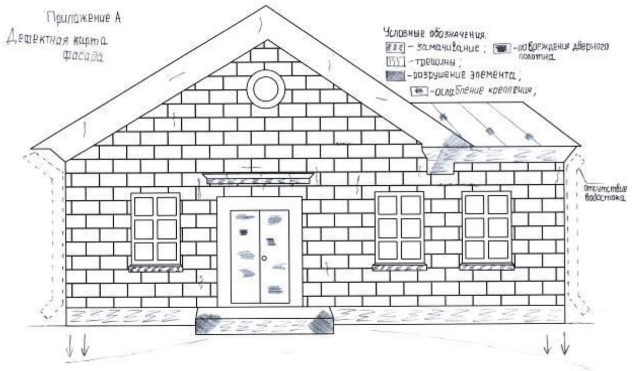
Рис.4. Дефектная карта элемента здания – наружной стены (пример)
