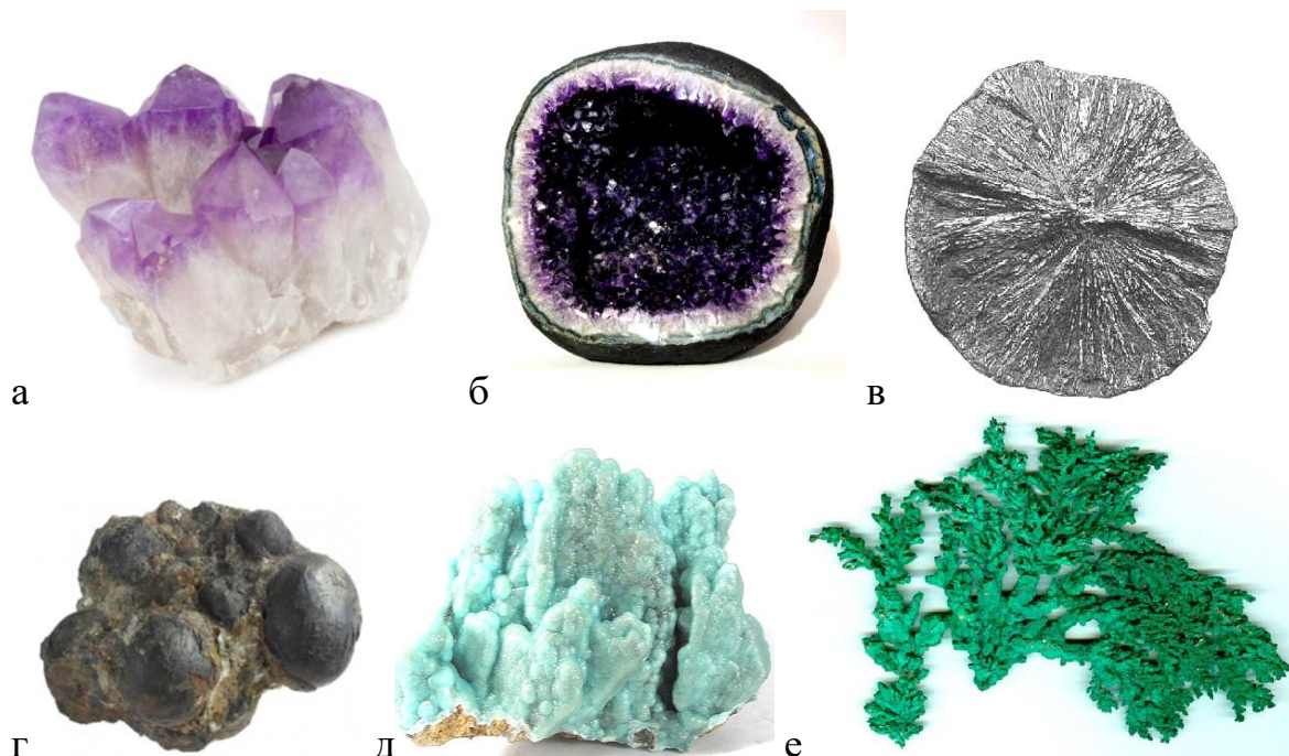
Рис. 1. Формы нахождения минералов в природе: а – друза кварца; б – секреция; в – конкреция; г – оолит; д – натечные формы; е – дендрит
