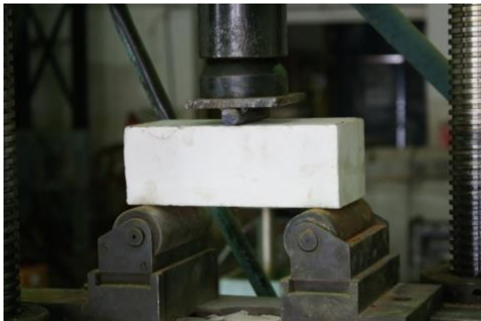
Испытание силикатного кирпича на изгиб
