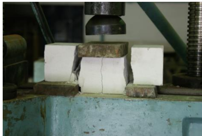
Испытание силикатного кирпича на срез
