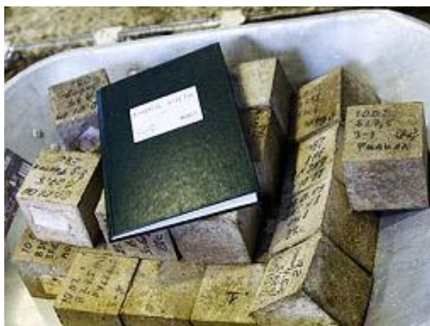
Бетонные кубы с размерами 100x100x100 мм
