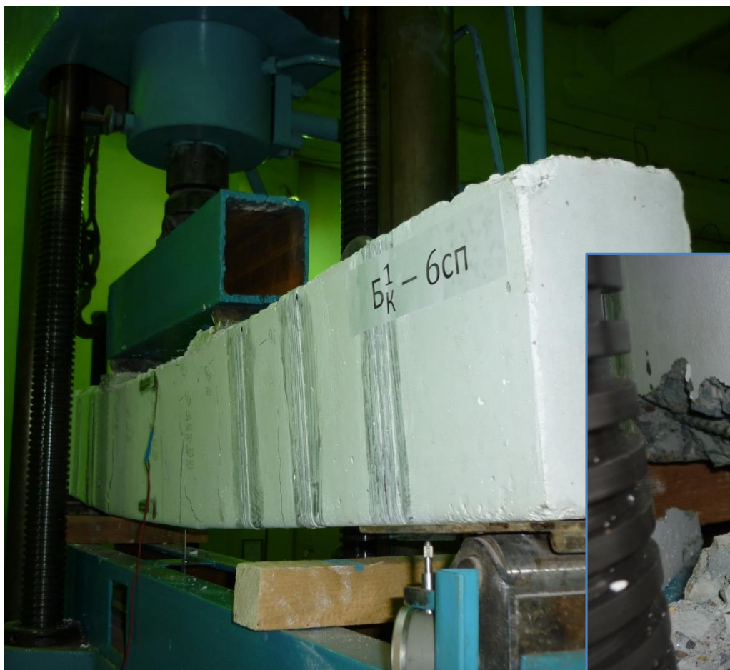
Прогиб балки достигает 50 мм
