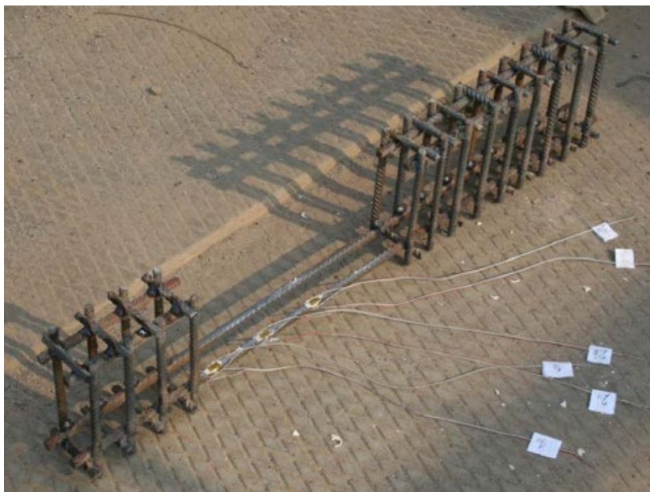
Рис. 5.2 Вид используемого армирования образца балки 3Б0-12-0-І
