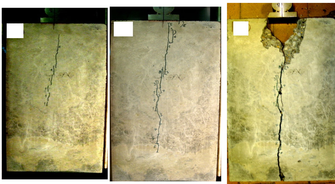
Рис. 3.21 -Характер образования и развития усталостной трещины (а), (б) и усталостного разрушения (в) бетонного элемента с размерами H/L = 3,67
