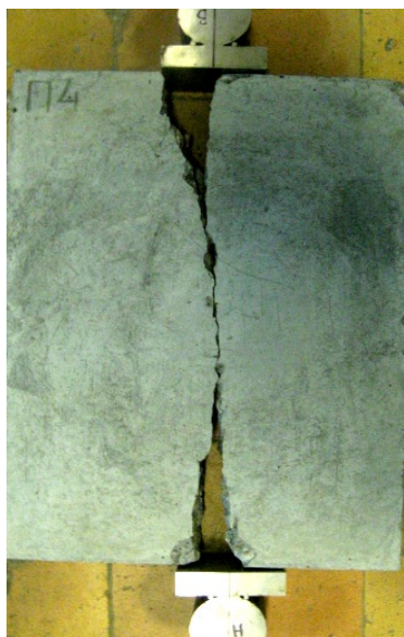
Рис. 3.20 -Характер образования и развития трещины раскалывания и разрушения бетонного элемента при \delta = l_{sup}/H = 0,2 и H/L = 1,33
