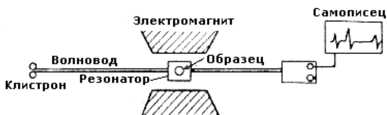
Рис. 5. Схема установки для регистрации спектров ЭПР.
