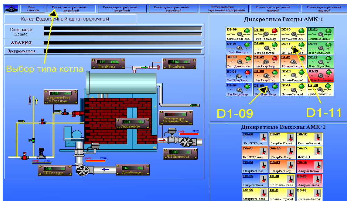
Рис. 3. Переключение модели котла и перевод переключателей D1-11 и D1-09 в исходное положение.
