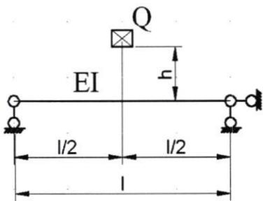
*Исходные данные:* На середину однопролетной балки падает груз весом  $Q = 2 \text{ кН}$  с высоты  $h = 0,3 \text{ м}$ . Пролет балки  $l = 6 \text{ м}$ , жесткость  $EI = 6000 \text{ кН}$ , вес  $Q_b = 5 \text{ кН}$ .
