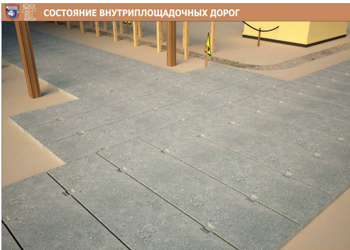
Рис.8. Устройство внутриплощадочных дорог из сборных железобетонных плит
