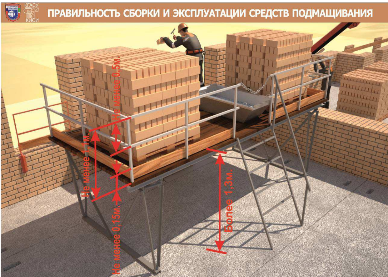
Рис.19. Устройство подмостей каменщика
