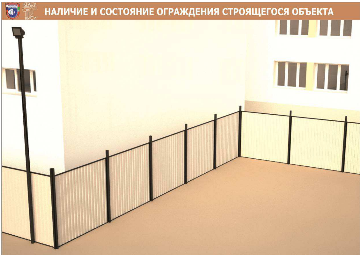
Рис.17. Ограждение строительной площадки
