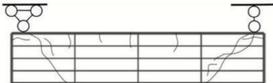
Рис. 13 Пример оформления схемы развития трещин
