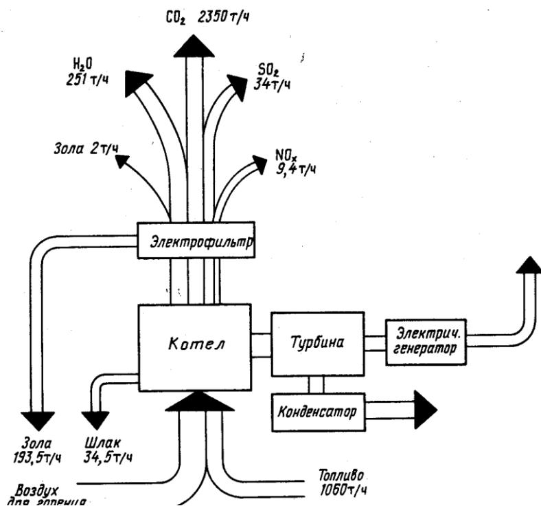
Рис. 1. Материальный баланс угольной ТЭС мощностью 2400 МВт
