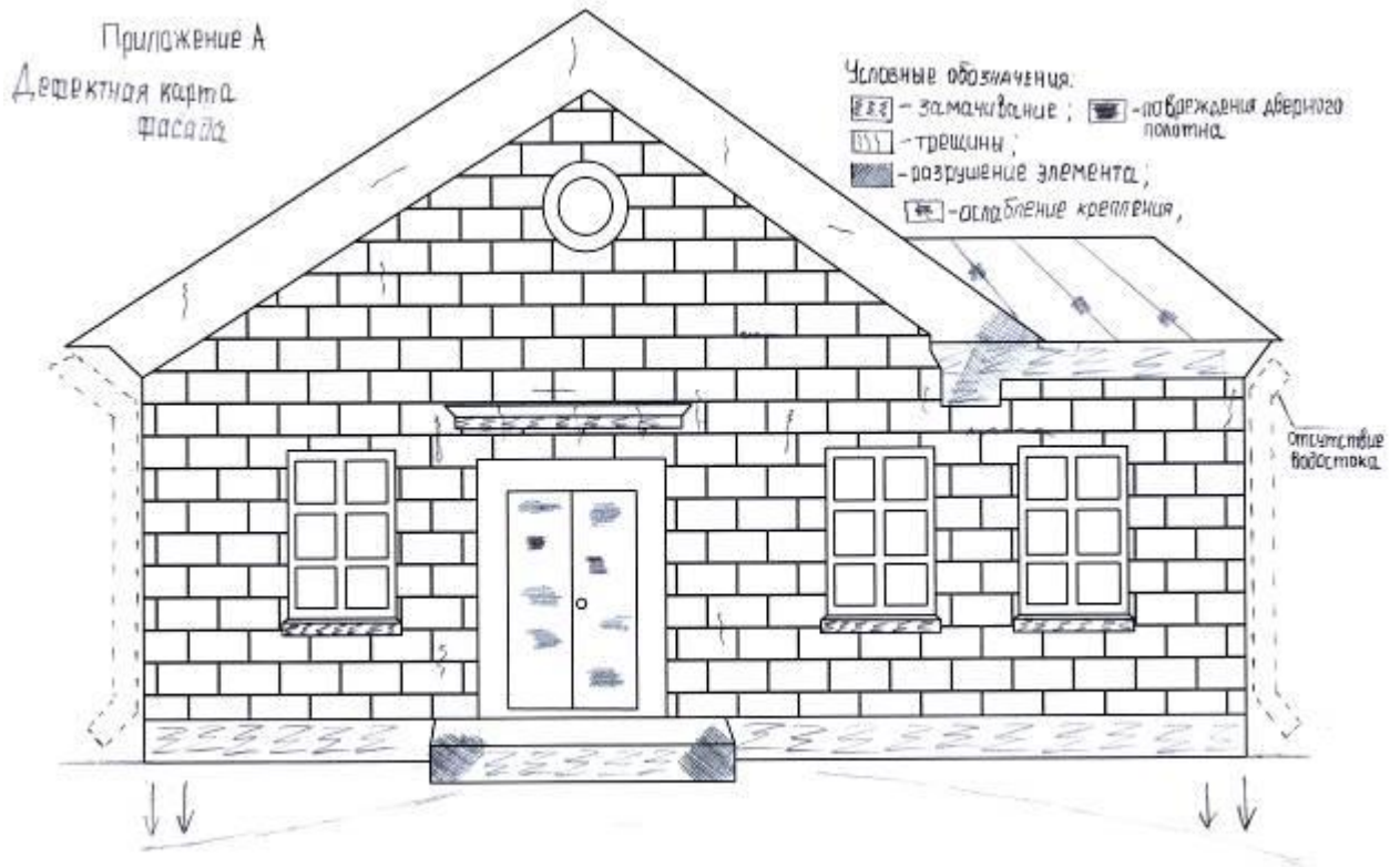
Рис. .... Дефектная карта фасада здания (пример)
